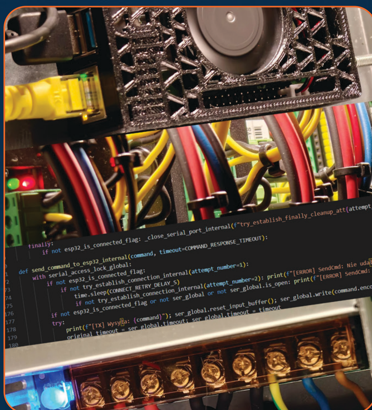
Fot. 2. Kluczowe komponenty systemu: serwer aplikacji (Raspberry Pi), logika sterowania, oprogramowanie i zasilanie.
